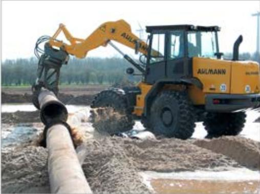
Radlader mit Rohrgreifer
